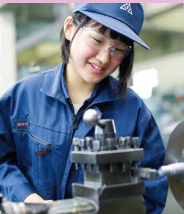
旋盤実習(機械系) 金属を回転させながら刃で切削する方法を学習します。
