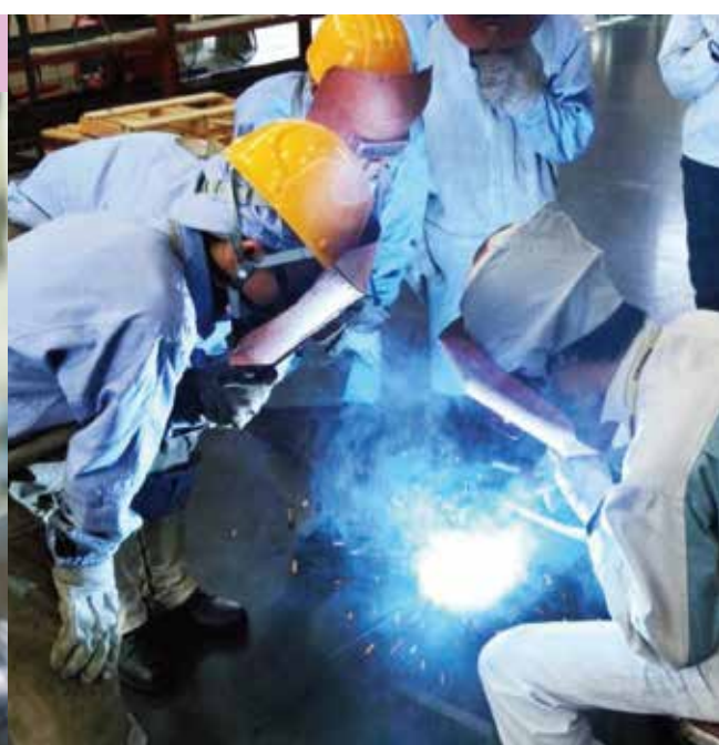
溶接実習(機械系) 金属を電気やガスなどによって溶かし接合する方法を学習します。
