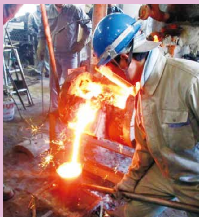
溶解実習(機械系) 液体にした鉄を型に流し込み、冷却して目的の形状に固める実習です。
