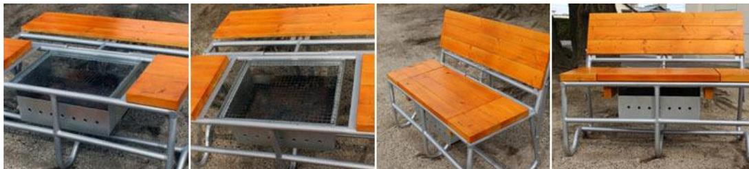
災害時にコンロとして使える「防災ベンチ」を製作。普段は大人2人がゆったり座れるサイズで、災害時には木製の座席部分を外すと鉄製コンロが現れ、背もたれは倒してテーブルになる。これまでに作成したベンチは、避難所に指定されている新居浜市内の公民館に設置している。
