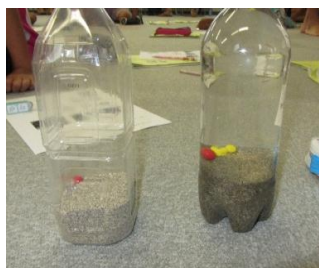
液状化の仕組みの実験1
